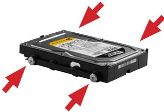
3. um Festplatten nachzurüsten montieren Sie die Laufwerksschienen aus den Laufwerksschächten wie abgebildet. Die nötigen Schrauben befinden sich im Lieferumfang.
