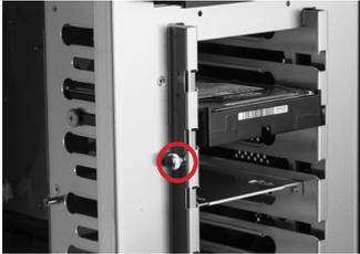
1. Lösen Sie die Rändelschraube an der Laufwerkssperre nur leicht an
