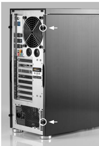
1. Lösen Sie die 3 Rändelschrauben (Abbildung ähnlich) auf der Rückseite des Gehäuses.
