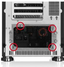
1. Lösen Sie die vier Netzteilsschrauben an der Rückseite des Gehäuses
