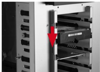
2. und ziehen Sie dann die Laufwerkssperre nach unten weg, so dass sich die Laufwerksschächte öffnen.
