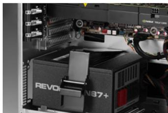
4. Entfernen Sie anschließend alle Kabel vom Netzteil und ziehen es vorsichtig heraus.
