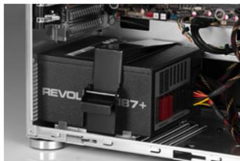
2. Öffnen Sie den Hebel der Netzteilhalterung.
