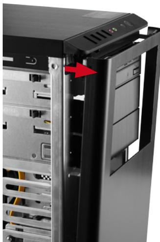
2. Ziehen Sie dann den unteren Teil der Blende aus der Führung im Gehäuse heraus
