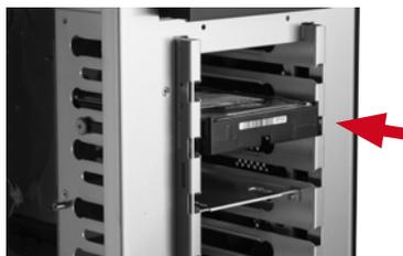
4. Schieben Sie die Festplatte in den Laufwerksschacht bis die Festplatte in der Backplane einrastet und arretieren Sie die Laufwerkssperre.
