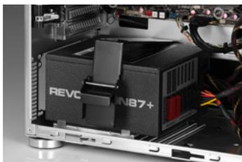
3. Lösen Sie die Netzteilhalterung aus der unteren Arretierung und anschließend aus der oberen Arretierung und entnehmen Sie die Halterung.
