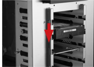
2. und ziehen Sie dann die Laufwerkssperre nach unten weg, so dass sich die Laufwerksschächte öffnen.
