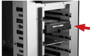
4. Schieben Sie die Festplatte in den Laufwerksschacht bis die Festplatte in der Backplane einrastet und arretieren Sie die Laufwerkssperre.
